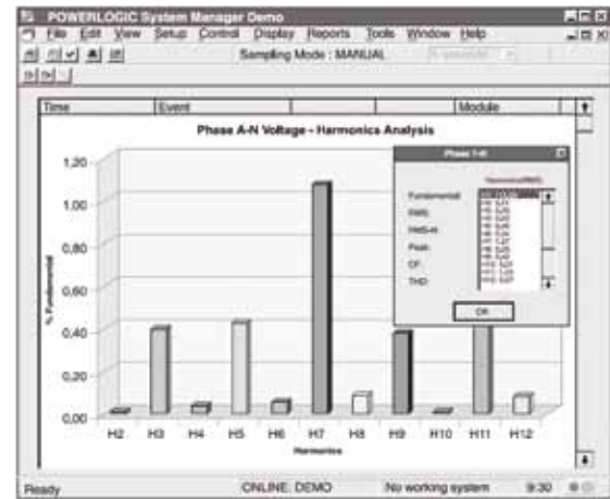
Måling af overharmonisk forvrængning, udført af et MicroLogic strømrelæ.
